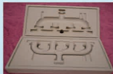
排气管砂模和砂芯，加工时间12小时 尺寸450mm × 220mm × 120mm
