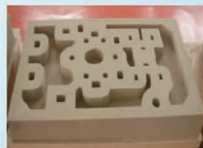
变速器箱体砂模，背后随型减重，加工时间8小时 尺寸1300mm × 770mm × 140mm
