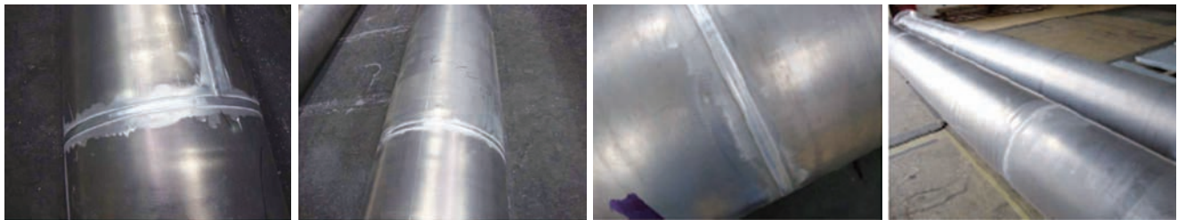
图5 TIG自动焊在上生产应用后工件图片
