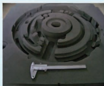
大型盘体砂模加工时间11小时 轮廓尺寸780mm × 780mm × 80mm
