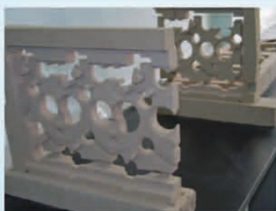
大型柴油机缸体砂芯，镂空加工时间10小时 尺寸500mm × 350mm × 80mm
