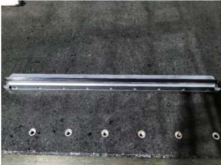
图 3 测试用刮刀结构
